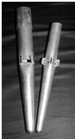
18. ábra Kettős ajakpárú és magas szélnyomással szóló sípok a szegedi Dóm orgonájának szólóművéről
