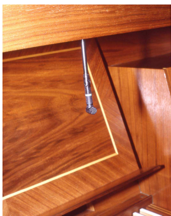
65-66. ábra: Mikrofon utólagos felszerelése spielschrankra (eredetileg nyakbaakasztós típus). A microphone beforgatható a perem alá.
