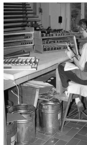
24. ábra Sípláb hajlítása sablonra verőfával
