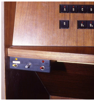
67. ábra: erősítő és microphone kapcsolók utólagos felszerelése.
