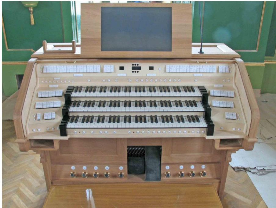
62. ábra: A Budai Ciszterci Szt. Imre templom új orgonájának mechanikus / elektronikus játszóasztala (Pécsi Orgonaépítő Manufaktúra; Terv: Dékány András; Kis Zoltán; Pour László, 2011-2012) a legmodernebb elektronikával és digitális kottatartóval felszerelve, a kántori munkához integrált segítőkkal. 10.000 setzer kombináció; USB-n 100×10.000 kombináció tárolható.
