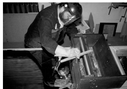
22. ábra Az ónlemez öntése
