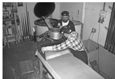
21. ábra Orgonafém-olvadék áttemelése az ónolvastóüstből az öntőpad szánkójára
