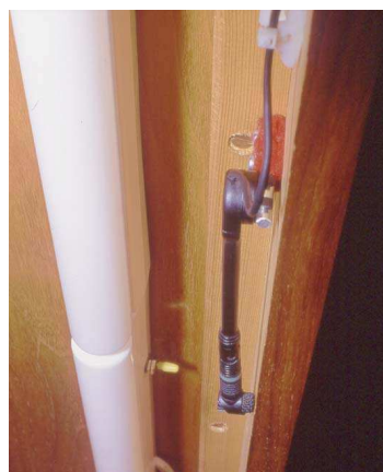
65-66. ábra: Mikrofon utólagos felszerelése spielschrankra (eredetileg nyakbaakasztós típus). A microphone beforgatható a perem alá.
