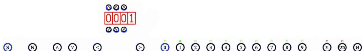
57. ábra. S: rögzítő (memóriagomb); N: „Num” gomb; Δ V: helyiértékbeállító gombok a központi kijelző alatt-felett illetve többszörözve kézinyomókban; < >: kombináció léptető vissza-előre; 0-9: kombinációgombok; PI: Plénium; UTt: Univerzál tutti; Ø nullázó.
