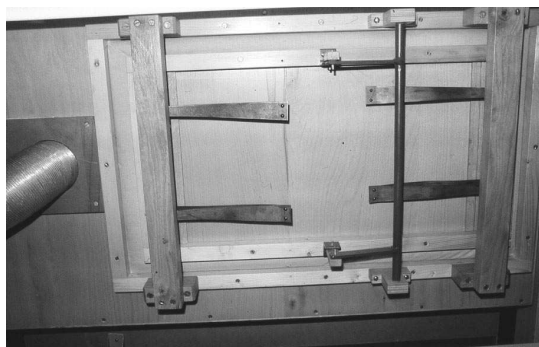
35. ábra Úszólemezes fúvó a szelláda fenekébe építve
